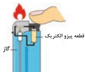
شکل ۱۲ (ج) - کاربرد پیزوالکتریک در فندک
